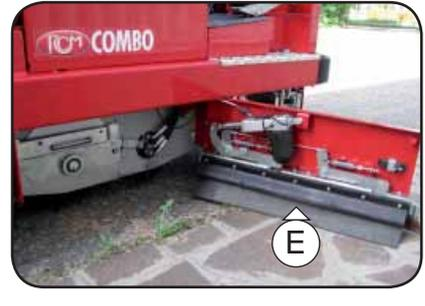
Los faldones (E),(F),(G) sirven para retener el polvo durante la fase de **barrido**, por ello es necesario que su funcionamiento sea siempre perfecto y sustituirlos en caso de rotura.
