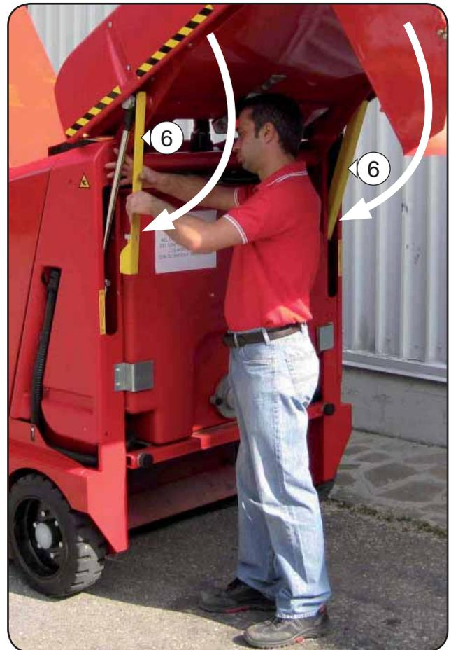
El contenedor de basura sirve para contener los desechos que recogen los cepillos. Para descargar los desechos en los cajones adecuados efectuar las siguientes operaciones:
