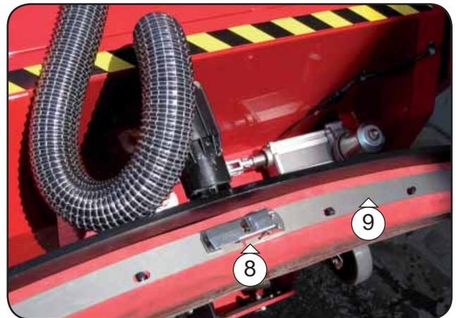
La función de las gomas de la boquilla de secado es retener el agua usada durante el Lavado, por lo tanto hay que conservarlas siempre en buen estado y sustituirlas si están rotas o gastadas.
