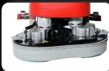
داشتن دو موتور گیربکس مجزا بر روی هر یک از برس ها
