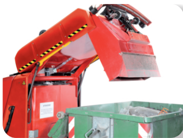
تخلیه زباله در مخزن به صورت هیدرولیک .
