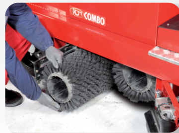
تعویض سریع برس های اصلی بدون نیاز به ابزار.
