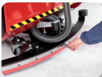
تعویض سریع لبه های لاستیک تی.
